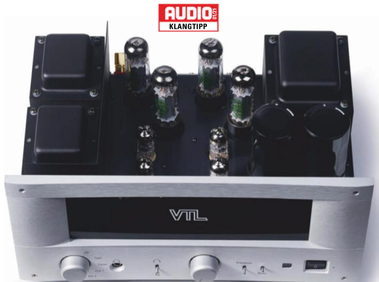
▲ **KLASSISCH:** Eingangs-/Preamp-Röhren je eine Doppeltriode 12AU7, Treiber je eine 12AT7, pro Kanal ein paar Endröhren-Pentoden-Paar EL34, dazu die Trafos.
