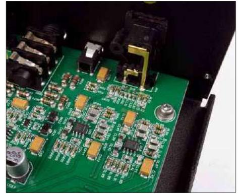
*Ab in die Ecke: Das Phonoteil ist komplett in SMD-Technik ausgeführt und sitzt weit entfernt vom Netzteil*
