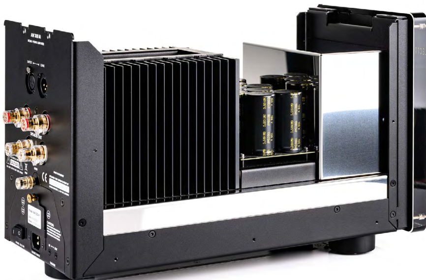
Producent dość poważnie potraktował kwestię chłodzenia. Jeden monoblok pobiera moc prawie 90 W (przy braku obciążenia) – pracuje w klasie AB.
